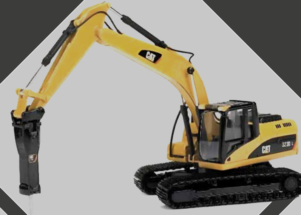
Retroexcavadora con martillo 1
